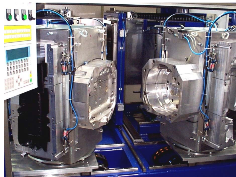
Specijalna mašina za serijsko zavarivanje obradaka velikih dimenzija
